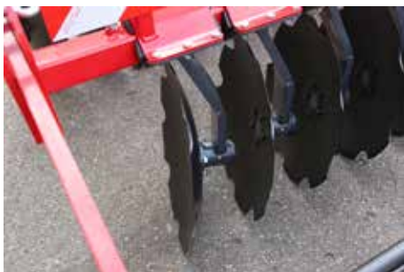
Suspension à barre de torsion des disques
