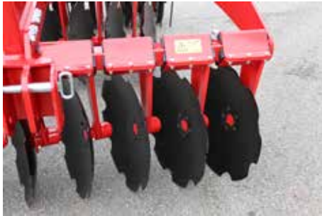
Suspension à barre de torsion des disques
